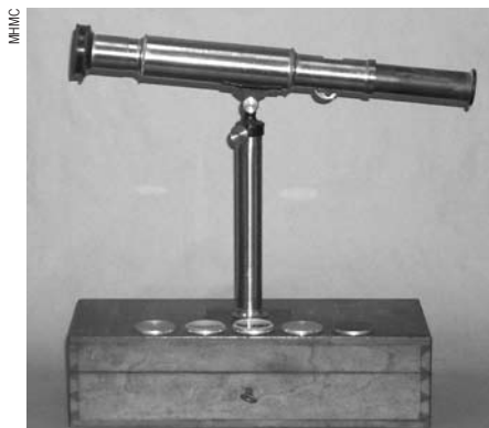
Optòmetre astigmatòmetre fabricat per al doctor L. Carreres Aragó per P. Roulot, París, 1879 · MHMC-287
